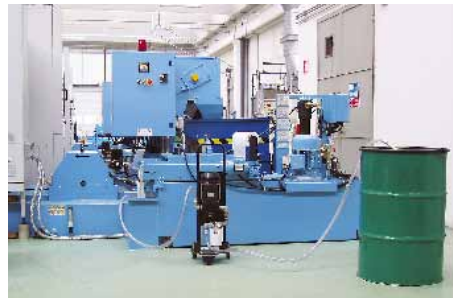
Typischer Anwendungsfall einer Ölreinigung bei einer Maschinenanlage mit Schmierstoffen
