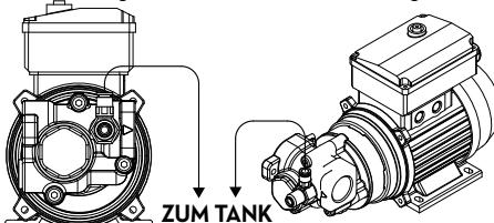
Falls die Installation mit einem Grundventil versehen ist, kann man die Füllvorrichtung nach Beendigung der Startphase schließen (siehe Abschnitt "13"). Will man hingegen das Entlüftungsventil immer offen lassen, ist auch zu berücksichtigen, daß ein Anteil des Öldurchflusses gleich  $0,5 \cdot 1/\text{min}$  im Behälter umläuft.
