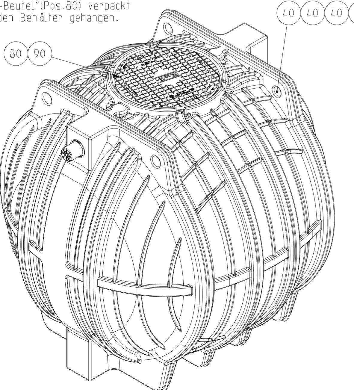
Die Spezialdichtungen (Pos.40) werden mit dem "Erntefülldegarn"(Pos.70) an einer der Kranösen befestigt.
