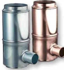
Filtern und sammeln Regenwasser für die oberirdische Speicherung. Adapter und Reduktion für Fallrohre DN 100, Maschenweite 0,315 mm.
