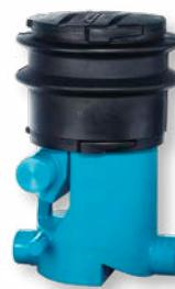
Erdeinbaufilter zum Anschluss mehrerer Regenfallrohre DN 100, komplett mit Teleskopverlängerung und Filtereinsatz aus Edelstahl, Maschenweite 0,55 mm.
