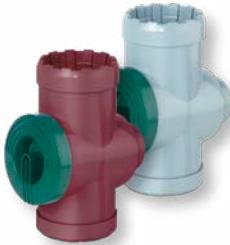
Filtern und sammeln Regenwasser für die oberirdische Speicherung. Adapter und Reduktion für Fallrohre Ø 80 - 100 mm, Anschlussstutzen DN 50 für Dachflächen bis 80 m<sup>2</sup>, Maschenweite 0,55 mm.
