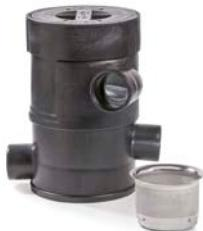
Erdeinbaufilter mit Anschluss DN 100, komplett mit Teleskopverlängerung und Filtereinsatz aus Edelstahl, Maschenweite 0,28 mm.
