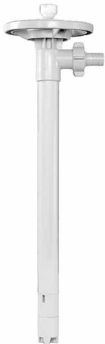
Das **Hoch-Temperatur Polypropylen (PHT)** Pumpwerk von Standard Pump ist zur Förderung von hochtemperierten korrosiven Flüssigkeiten geeignet. Robustes Polypropylen und eine Welle aus Hastelloy sichern die chemische Beständigkeit sowohl gegen leichte als auch aggressive Chemikalien.
